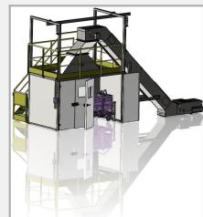
Collectage des copeaux , séparation entre pièces et copeaux, broyage, essorage en cycle automatique, stockage, compactage.
