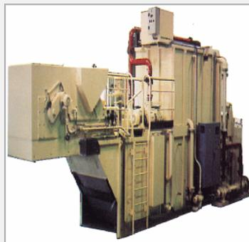
Le filtre OMSAT TYPE FRD est un filtre à dépression à toile horizontale continue, à mouvement discontinu. Le principe utilisé est celui de [la filtration](#) sur gâteau en fond de cuve.
