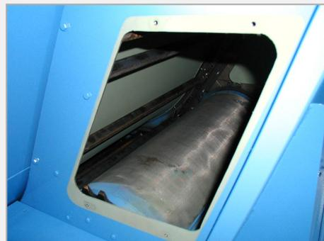
Ensemble monobloc constitué d'un ou plusieurs convoyeurs de copeaux et d'un [filtre autonettoyant](#) sans consommable. Economies sur les coûts d'exploitation. Cet ensemble est spécialement conçu et adapté pour les centres d'usinage. Il permet de traiter tous types de copeaux et de liquides de coupe. Le seuil de filtration atteint les 50 microns. Le débit est variable suivant les machines. Ses avantages: un meilleur usinage et une plus grande longévité du liquide.
