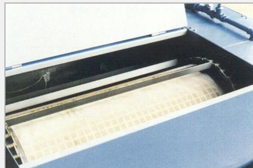
Ce filtre a un fonctionnement complètement automatique et permet de filtrer tous les liquides de coupe jusqu'à une finesse de 30 microns, sans média filtrant. Des économies sur les coûts d'exploitation sont possibles car il n'y a pas de consommation de papier, ni frais de recyclage de celui-ci. Les frais d'entretien sont réduits uniquement aux frais d'interventions périodiques.
